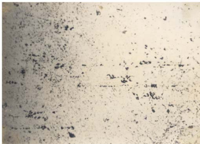
Hình 7.3-Tổ chức tế vi của đura sau nhiệt luyện
